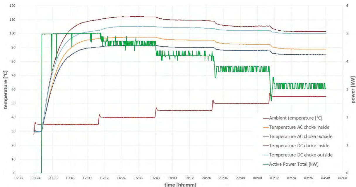
Rysunek 13: Wykres temperatury otoczenia i mocy wyjściowej dla pasywnie chłodzonego falownika ( P_{AC} = 5 \text{ kW} , U_{mpp,min} = 175 \text{ V} ) [źródło: pomiary Fronius]
