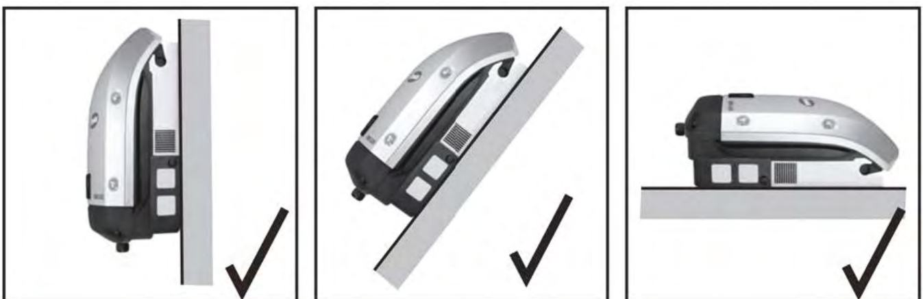
Rysunek 2: Elastyczne opcje montażu dla aktywnie chłodzonych falowników Fronius [źródło: Fronius]
