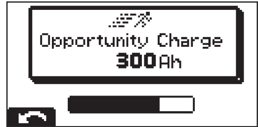
Affichage lors du démarrage de la charge intermédiaire
