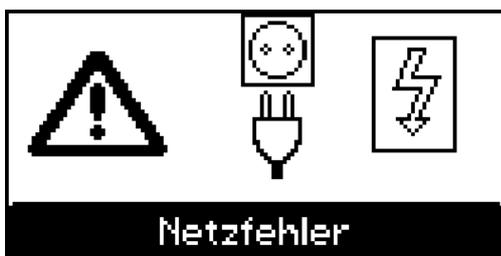
Netzfehler - Netzspannung außerhalb des Toleranzbereiches
