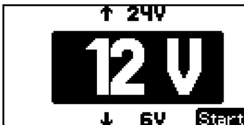
Das Ladegerät erkennt die angeschlossene Batterie automatisch, z.B. 12 V und stützt die Bordelektronik des Fahrzeuges nach 5 s.
