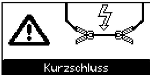
Kurzschluss der Ladeklemmen oder des Ladekabels, Kurzschluss-Erkennung aktiv
