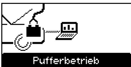
Der Pufferbetrieb entlastet die Fahrzeug-Batterie während einer Diagnose oder eines Software-Updates am Fahrzeug.
