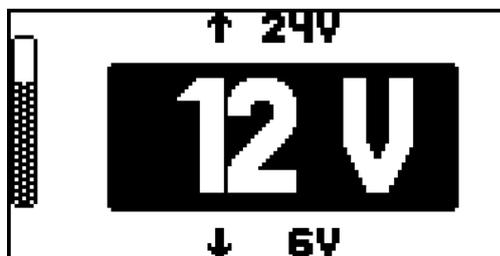
Das Ladegerät erkennt die angeschlossene Batterie automatisch, z.B. 12 V und startet den Ladevorgang nach ca. 5 s.
