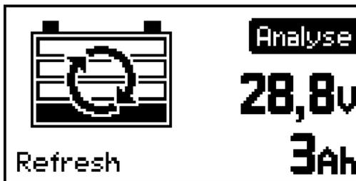
Während der Analysephase überwacht das Gerät die Batteriespannung, und das Ergebnis dient dem weiteren Ladeprozess.
