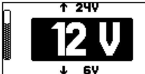
Das Ladegerät erkennt die angeschlossene Batterie automatisch, z.B. 12 V und startet den Puffervorgang nach 5 s.
