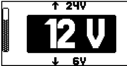
Das Ladegerät erkennt die angeschlossene Batterie automatisch, z.B. 12 V und startet den Ladevorgang nach 5 s.
