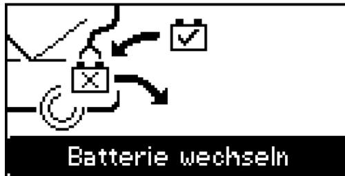
Die Betriebsart Batterie-Wechsel ermöglicht eine unterbrechungsfreie Stromversorgung der Bordelektronik bei einem Wechsel der Batterie.
